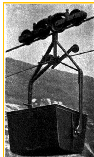
Obr. 22 Vozík lanovky a typický lanovkový pilier (zdroj Eisele 1907, http://www.zeno.org/Roell-1912/A/Seilbahnen )
