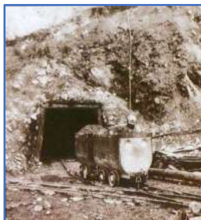
Obr.: 78 Ručná koľajnicová doprava azbestonosnej suroviny na závode Azbest Dobšiná okolo roku 1960
