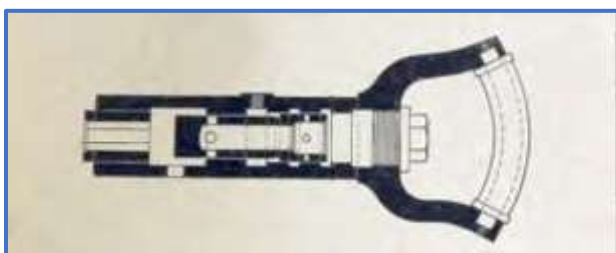
Vrtacie kladivo Hardsocg č. 20 a Hardsocg č. 2
