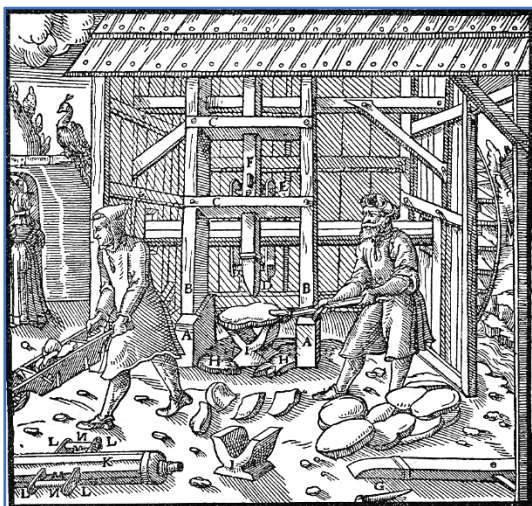
Kovanie železného koláča kladivom buchara v hámri (podľa Agricola 1556)
